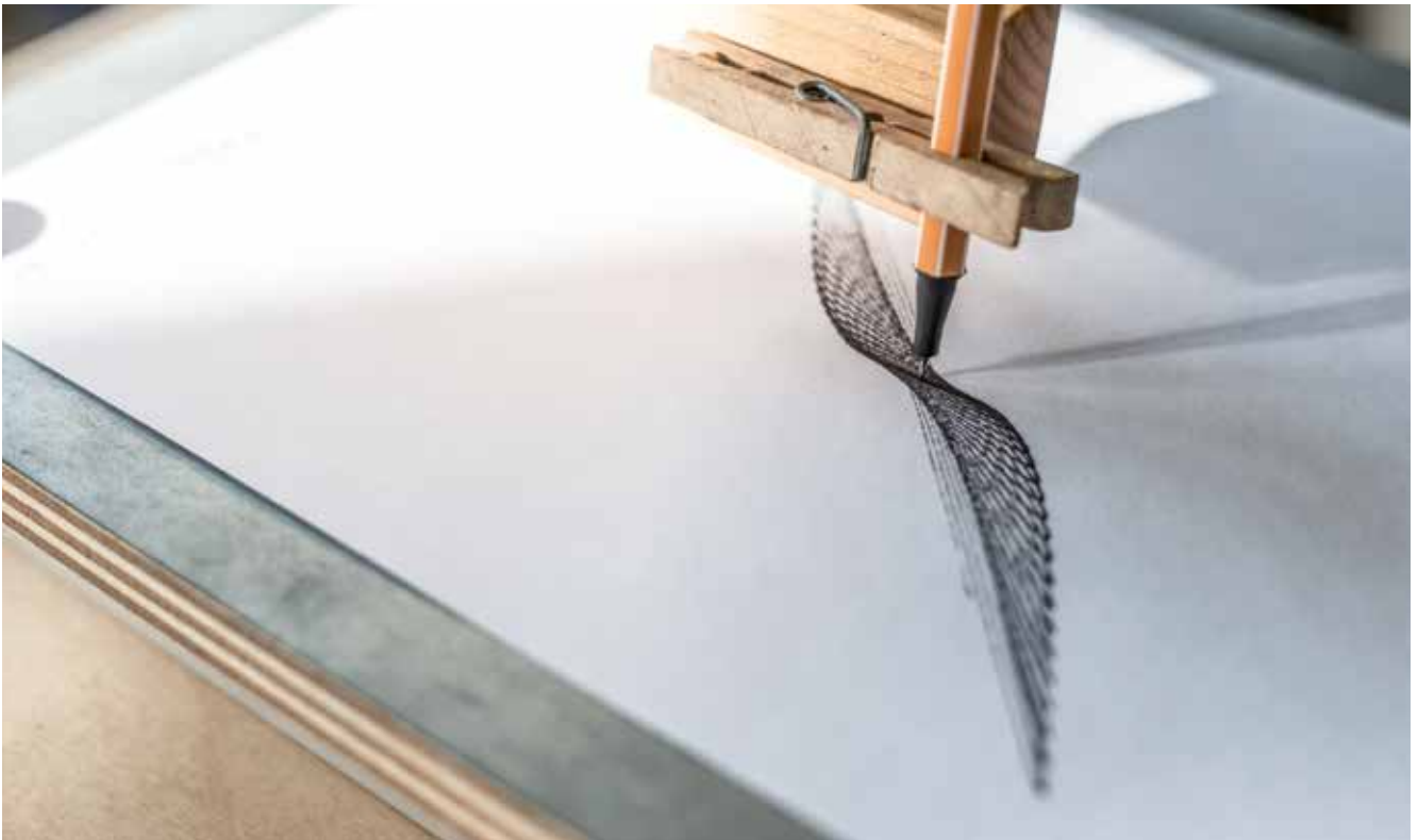
oben Dank zweier schwerer Pendel kann der Lissajous-Automat von Linda Rank Schwingungen visualisieren.
